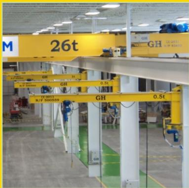
Этот тип крана предназначен для подъема и перемещения материалов с небольшим весом во время производственного процесса, что обеспечивает автономность некоторых рабочих мест по отношению к основным кранам в здании.
