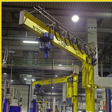
Этот тип крана предназначен для подъема и перемещения материалов с небольшим и средним весом во время производственного процесса, что обеспечивает автономность некоторых рабочих мест по отношению к основным кранам в здании.
