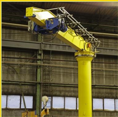
Этот тип крана предназначен для подъема и перемещения материалов с большим весом во время производственного процесса, что обеспечивает автономность некоторых рабочих мест по отношению к основным кранам в здании.
