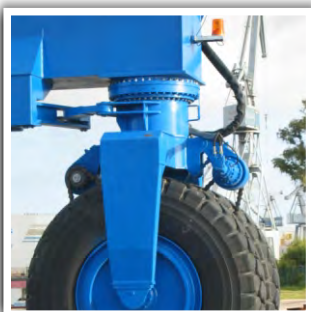
DIREÇÃO ROBUSTA PROPORCIONAL AO RAIO DE ROTAÇÃO
