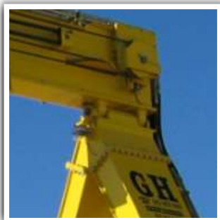
КОНСТРУКЦИЯ С ШАРНИРНЫМ СОЕДИНЕНИЕМ
