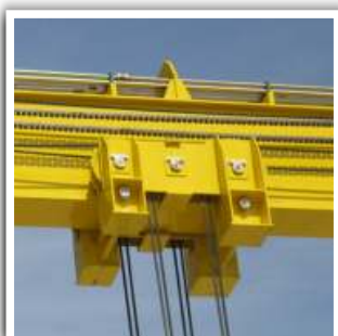
КАРЕТКА С ОГРАНИЧИТЕЛЕМ ГРУЗОПОДЪЕМНОСТИ И СУММАТОРОМ НАГРУЗКИ
