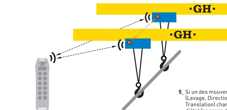
3\_ La communication s'établira automatiquement entre l'émetteur du pont Maitre et les récepteurs installés sur les 2 ponts roulants.
